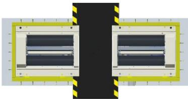
Mit Grube bestehend aus zwei getrennte Fundamentrahmen als Kantenschutz
